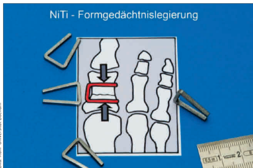
Anwendung von Memorymetallen in der Medizintechnik: Durch Anlegen einer Spannung nimmt die Klammer wieder ihre ursprüngliche Form an, so dass die Brüche fixiert werden können.
